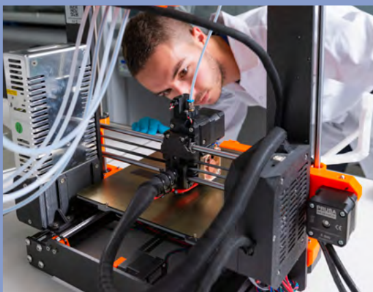
Création d'une cellule de batterie lithium-ion par fabrication additive. Cyril FRESILLON / LRCS / CNRS Images
